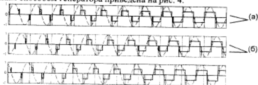
Рисунок 4 – Работа стандартного синхронизированного 6-импульсного генератора из библиотеки Power System Blockset / Extra Library / Control Blocks (а) и генератора, собранного из элементарных блоков Simulink (б)
